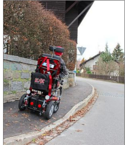
Bei einer solchen Schräglage könnte der Rollstuhl umkippen.
